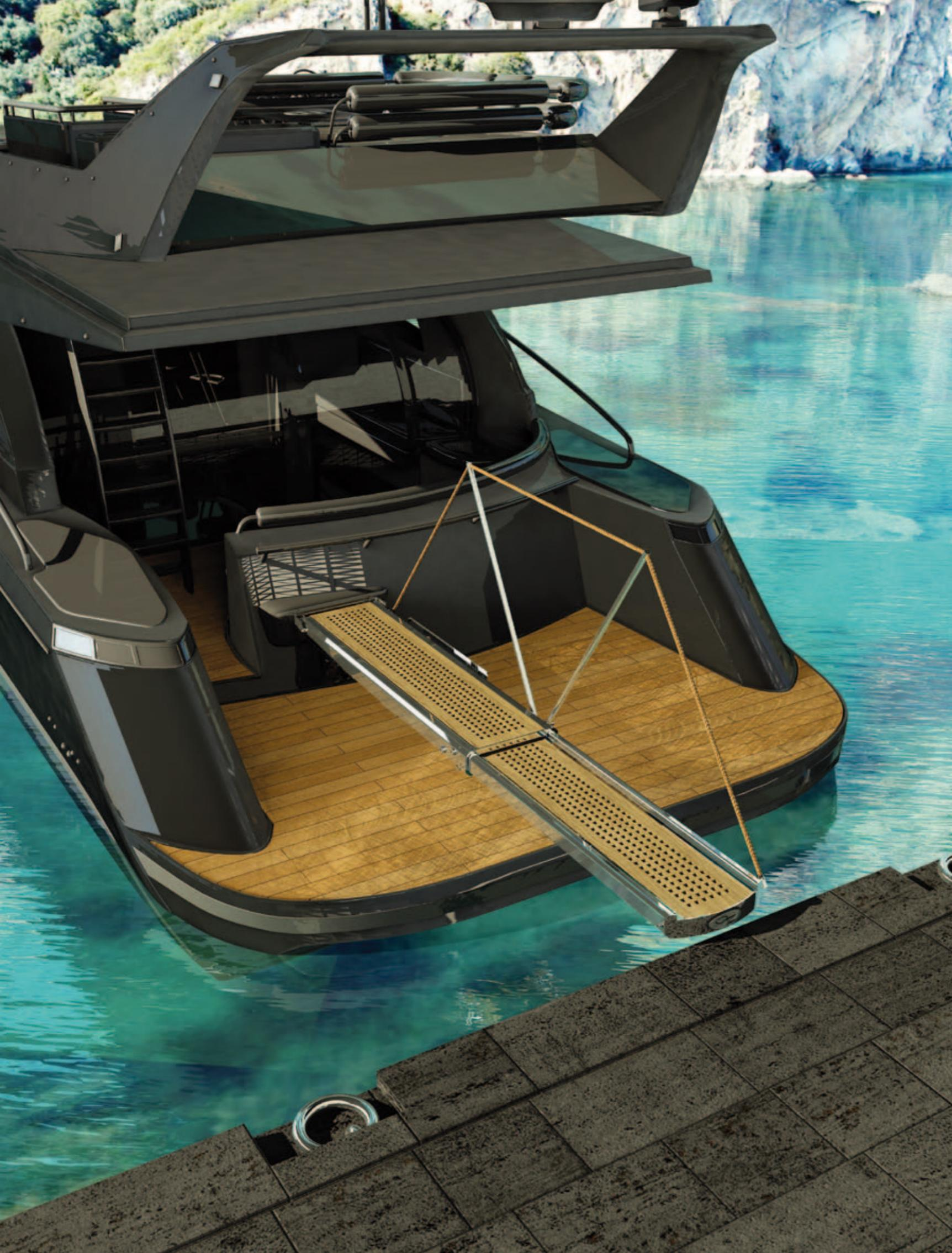
Passerella idraulica telescopica, con struttura a sezione poligonale, in acciaio inox AISI 316, lucidato a specchio.
