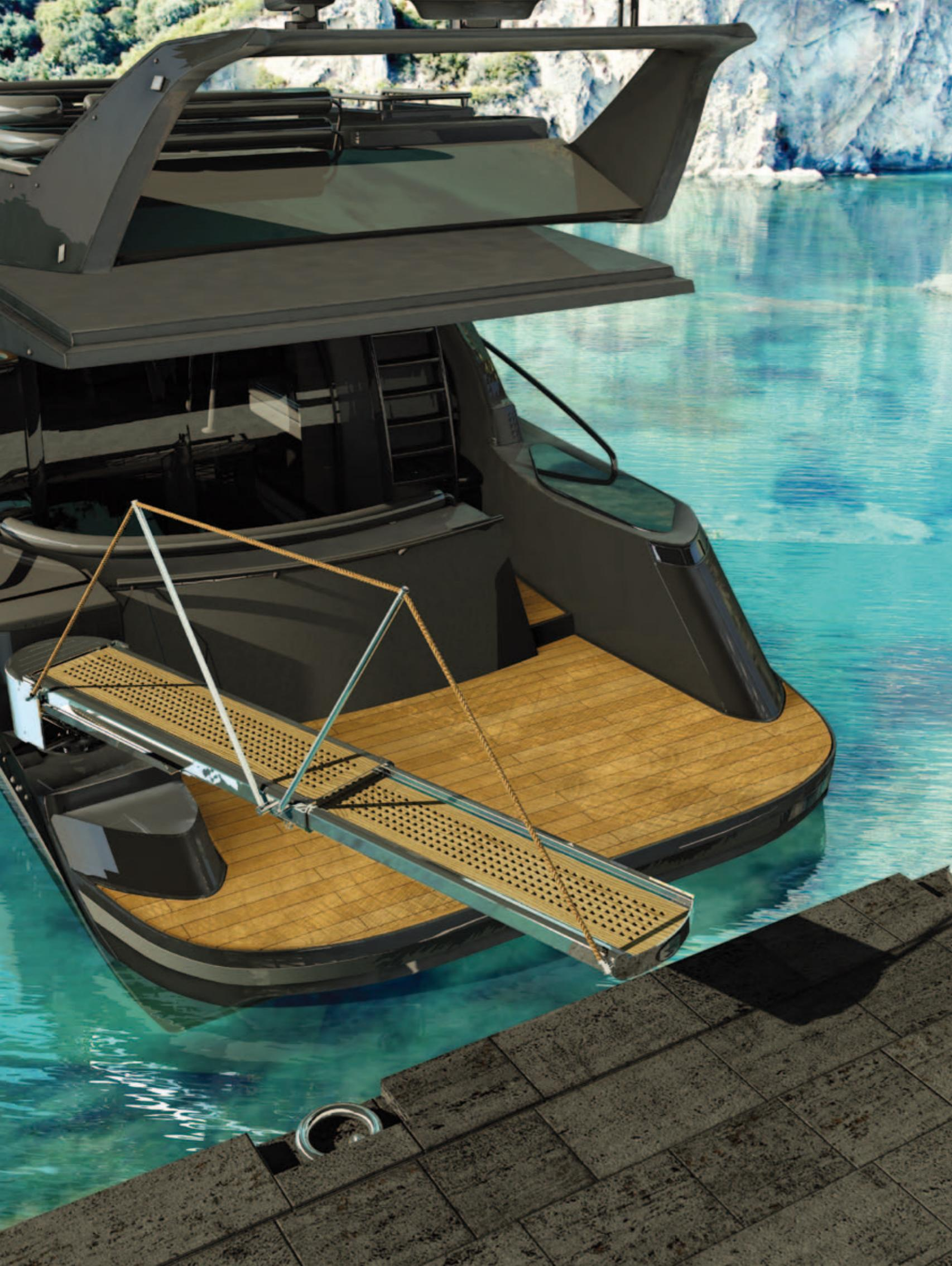
Passerella con torretta idraulica girevole e struttura in acciaio inox AISI 316, lucidato a specchio.
