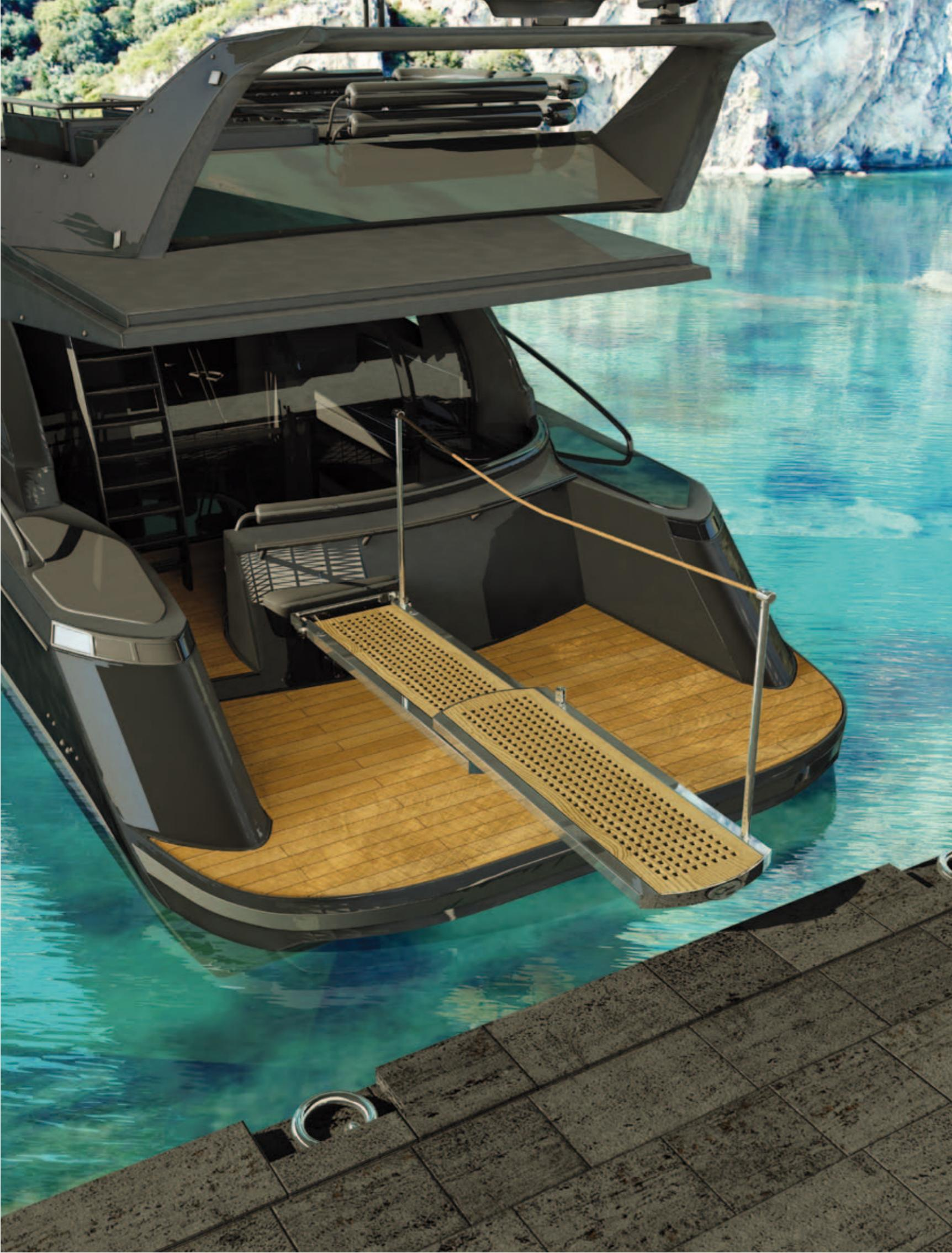
Passerella semiautomatica rotante, con struttura a sezione quadrata in acciaio inox AISI 316, lucidato a specchio.
