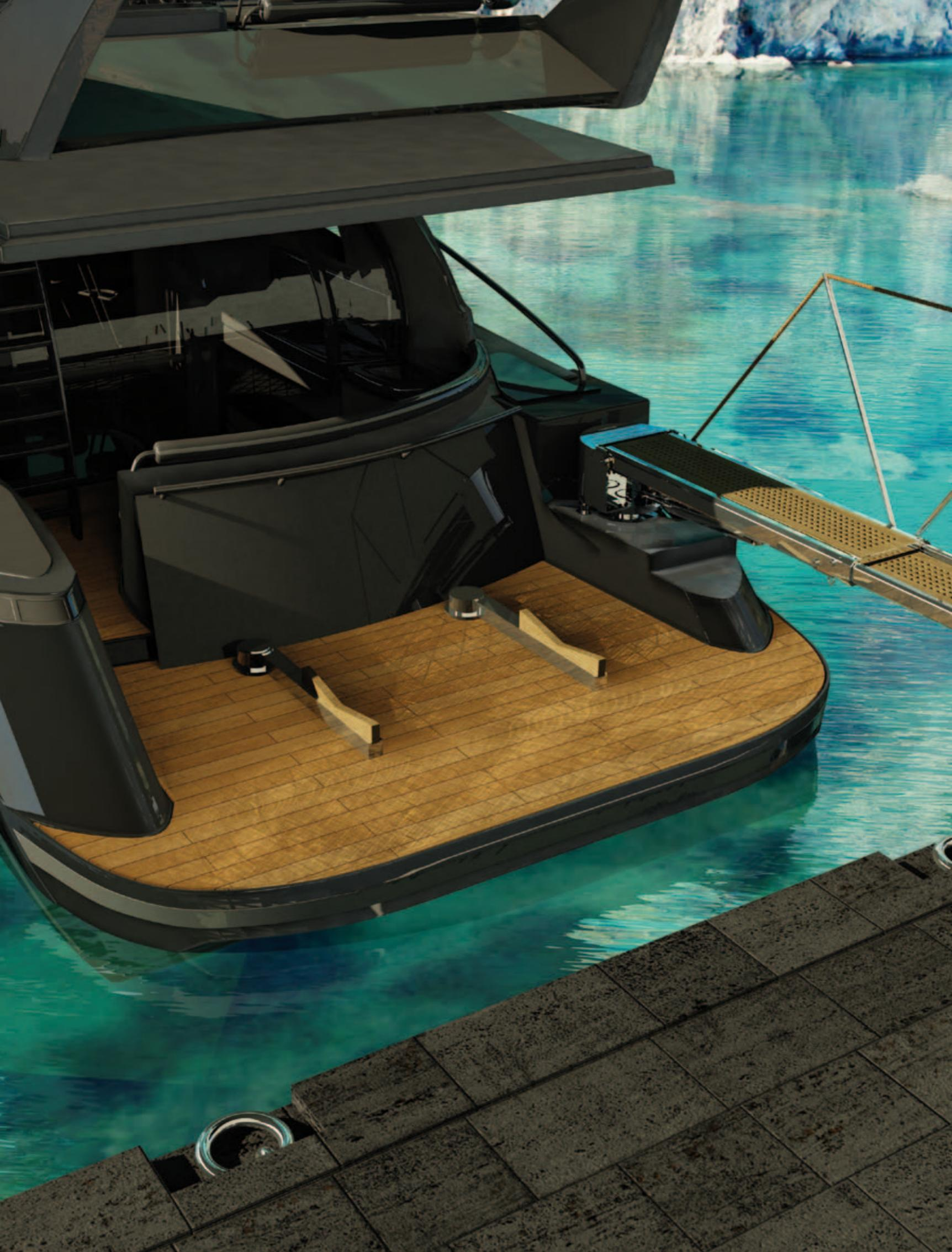
Coppia bracci per appoggio gommone, con struttura in acciaio inox AISI 316, lucidato a specchio.
