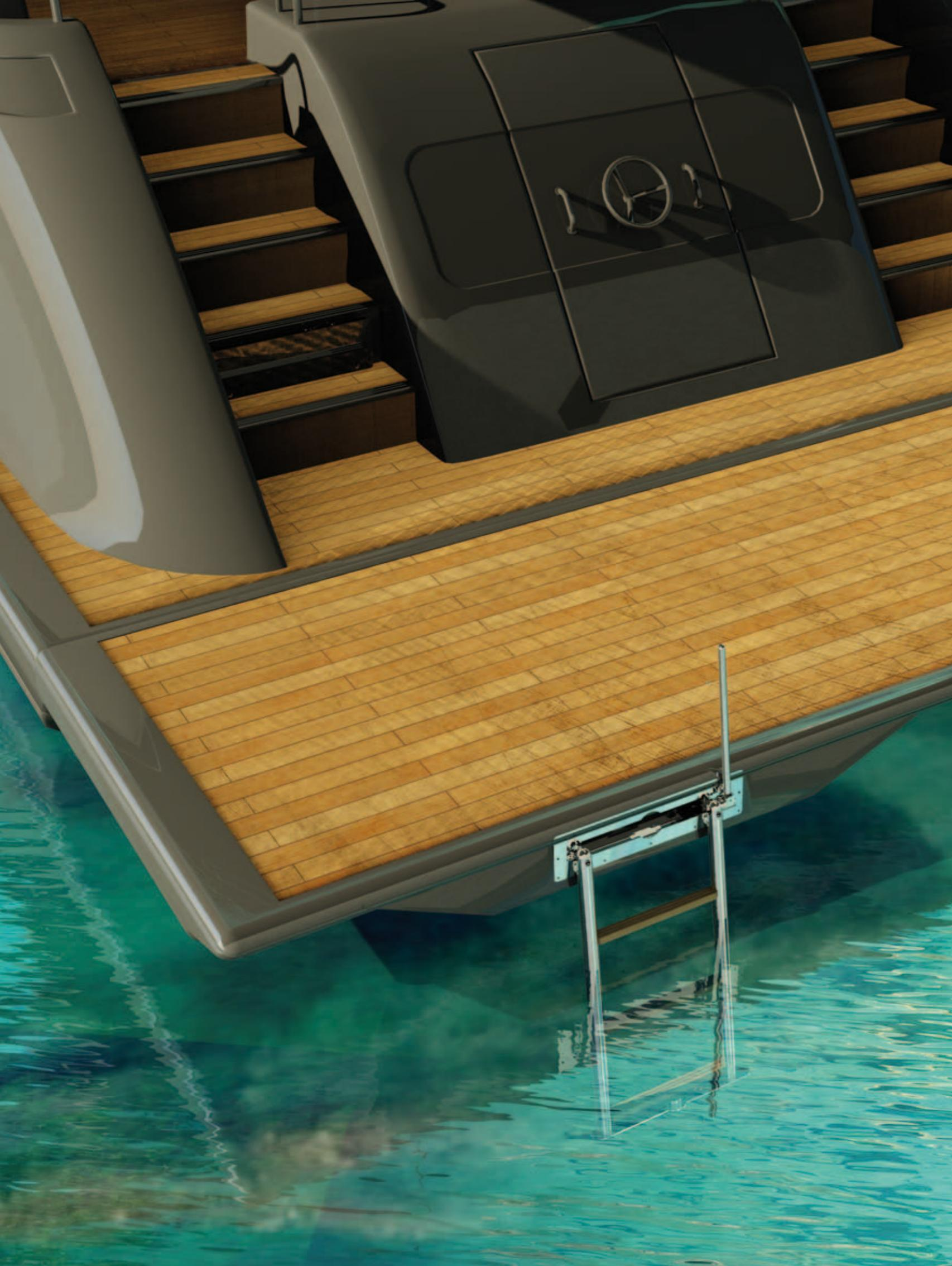
Scaletta manuale, con struttura in acciaio inox AISI 316, lucidato a specchio.
